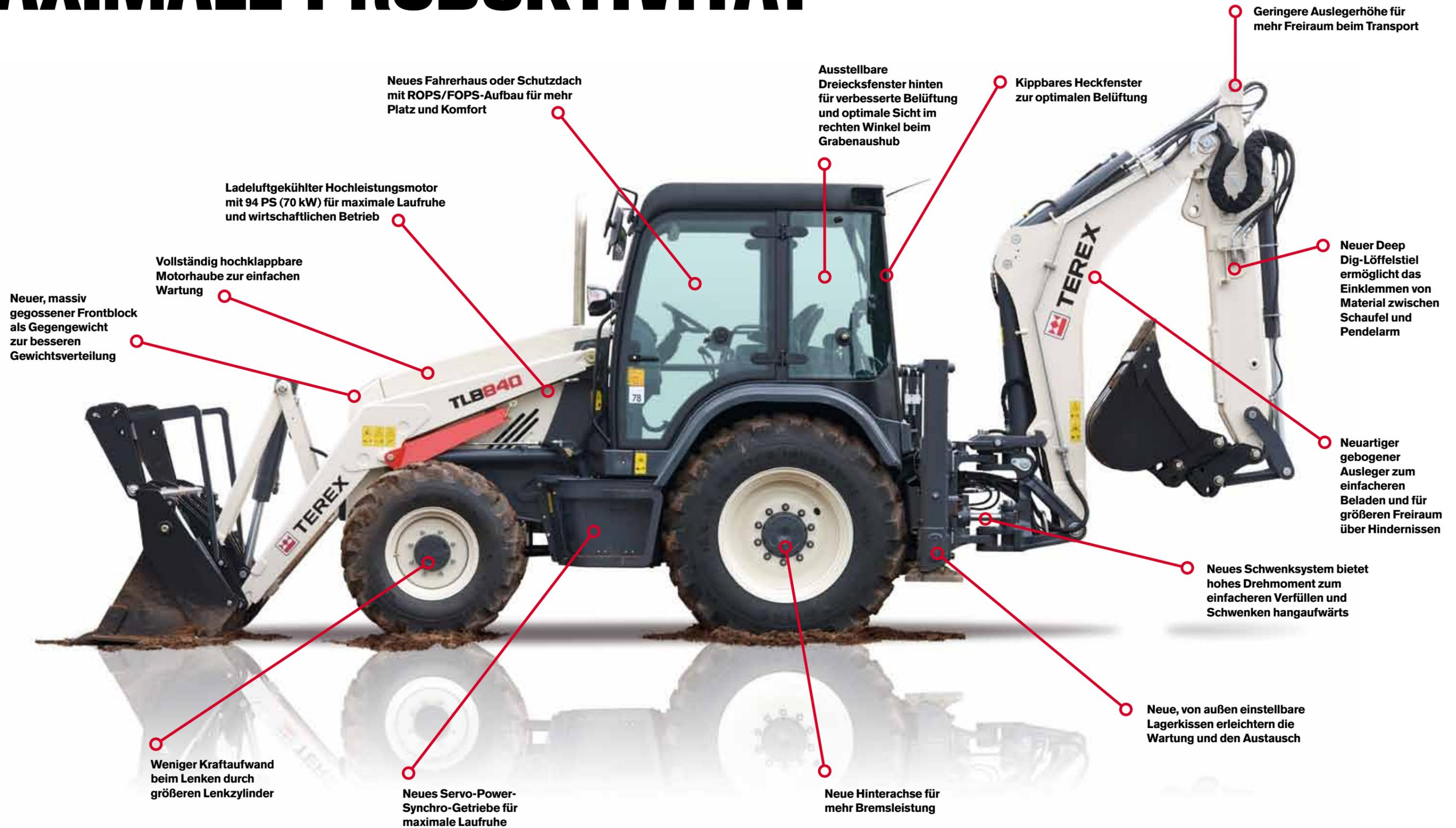
Neues Fahrerhaus oder Schutzdach mit ROPS/FOPS-Aufbau für mehr Platz und Komfort
